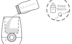
الخطوة الأولى: صب كمية مناسبة من الماء للتنظيف داخل جهاز التدفئة ملحوظة: عند تسيير المصوّر أو كيس حليب الأم أو طبع الطعام، يرجى إضافة ١٤ مل من الماء للتنظيف.
